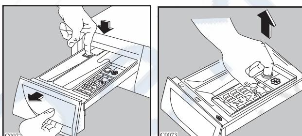
Стиральный порошок может также скапливаться в отсеке, в который устанавливается дозатор: прочищайте его с помощью старой зубной щетки. После чистки установите дозатор на место.
